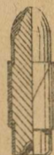
Proiettile del fucile svizzero Rubin-Schmidt N. 89 (Rivestimento punta metallica corpo di carta)
