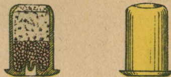
Cartuccia da salve M. o 90-99 per pistola a rotazione M. o 74-89
