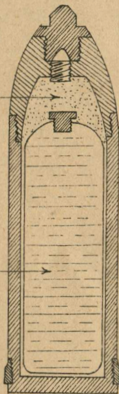
Fig: 1 = Tipo di proiettile a gas velenosi per artiglierie. Scala 1:10
